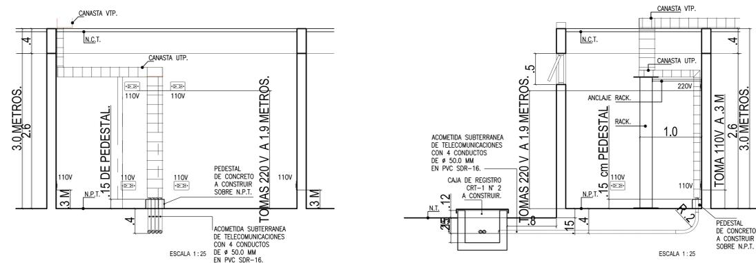
DETALLE DE CANALIZACION DE FIBRA ÓPTICA (4 PVC SDR-16) SIN ESCALA
