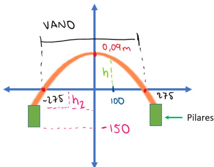
donde  $h$  es la altura del arco a los 100 m desde centro y  $h_2$  la distancia entre el apoyo del arco con la plataforma y el vano es el espacio del puente que queda dentro de la parábola
