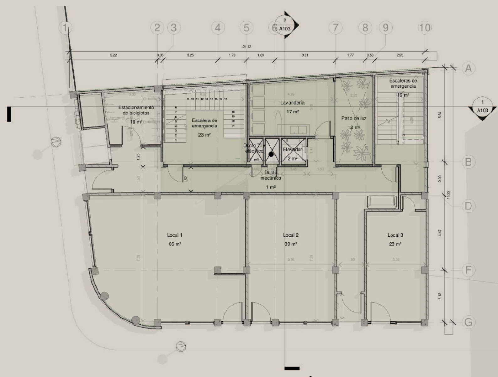
PLANTA ARQUITECTÓNICA NIVEL 1
