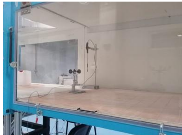
Figura 1. Montaje del anemómetro de copas.
