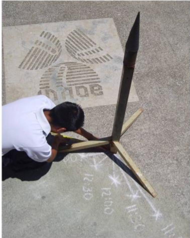
Figura 1.6: Trazos de las sombras del trípode en el suelo a varios tiempos. En el extremo de la sombra se trazó una cruz para denotar la longitud de la sombra en cada tiempo. Los tiempos están anotados junto a cada línea.
