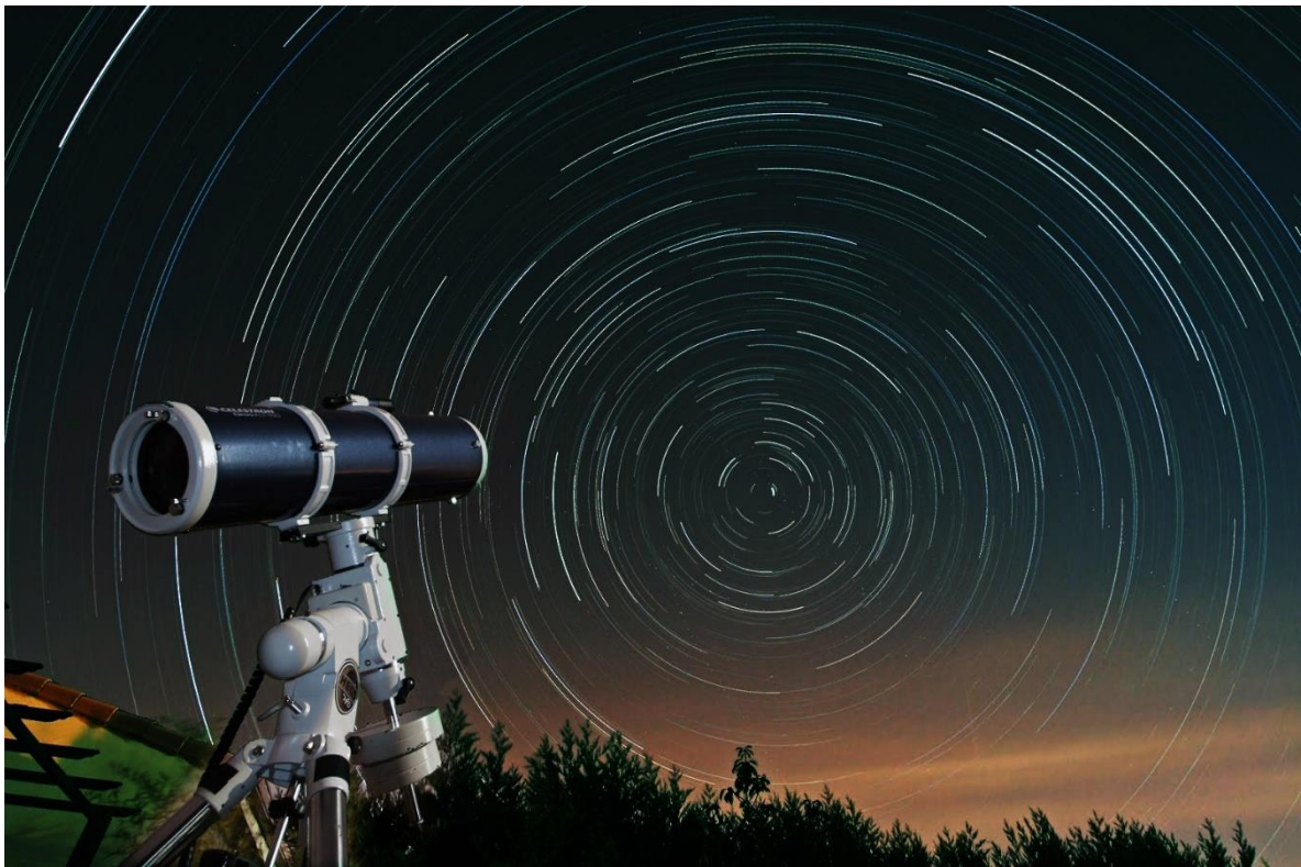
Figura 5. Estrellas Girando alrededor del eje Polar. Los telescopios con montura ecuatorial como el mostrado en la figura, se alinean usando la estrella polar como referencia.
