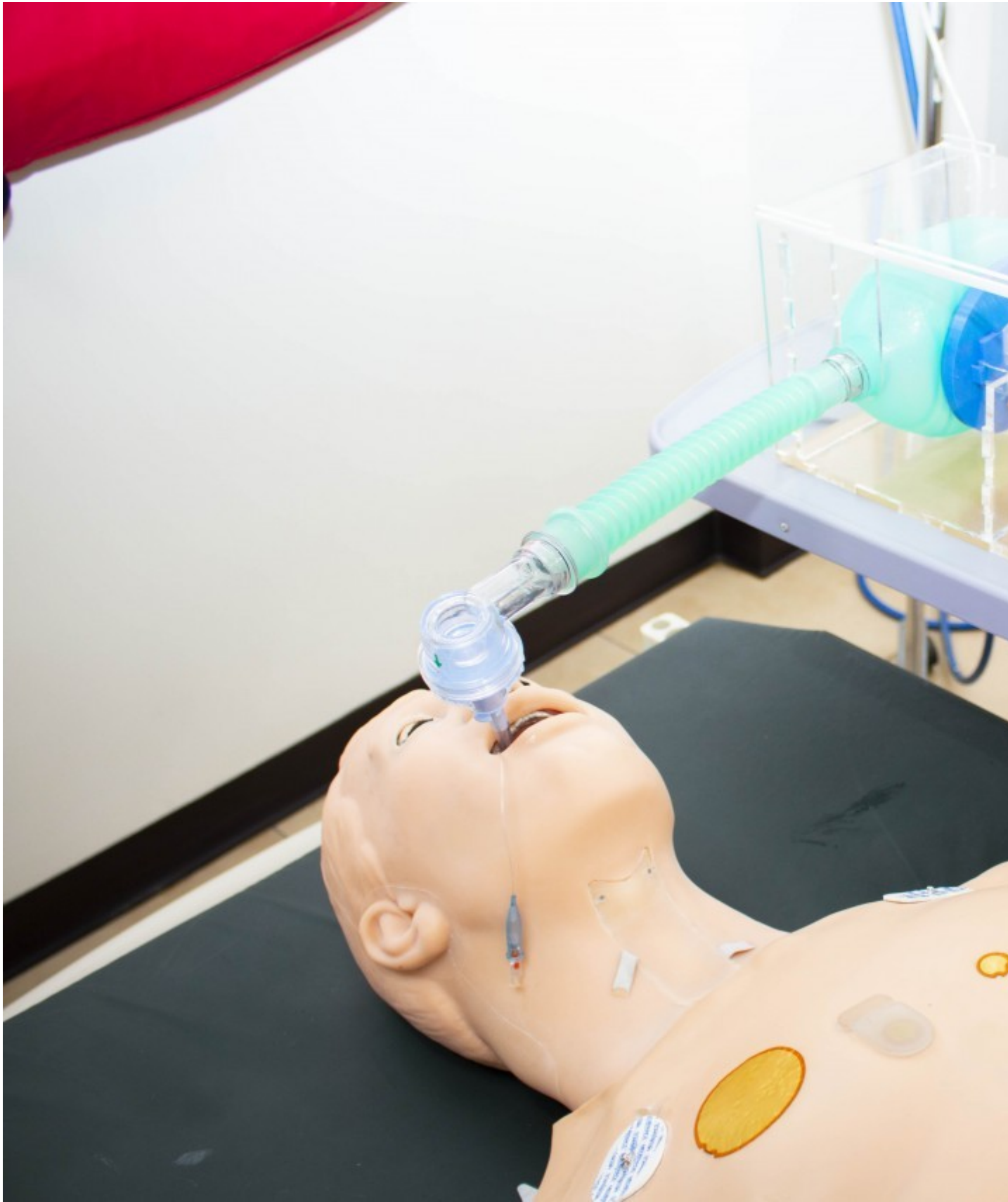
La primera versión del respirador era en acrílico. Hoy es en acero inoxidable.
