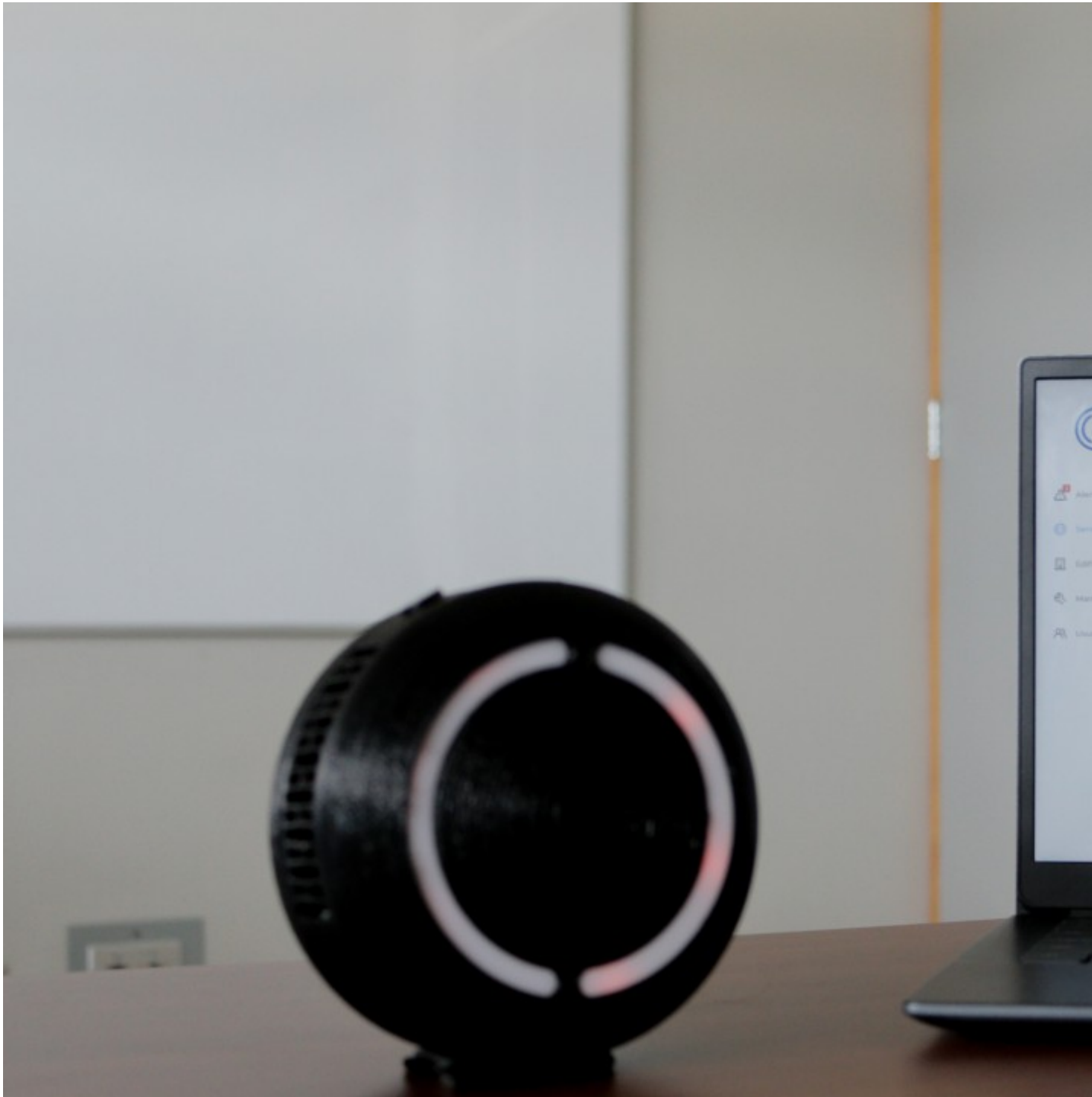
El dispositivo cuenta con un sensor que le permite detectar el CO 2 del lugar según el rango en el que se encuentre la concentración de ese gas. Foto: Steven Moya/TEC.
