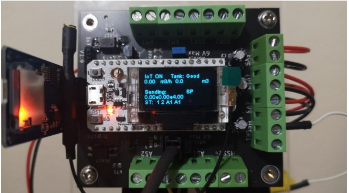
Una de las computadoras o dispositivo de Internet de las Cosas (IoT, en inglés), que envía datos en tiempo real y determina el funcionamiento del sistema. Este es el que se colocó en el tanque principal del acueducto de Sámara. Foto: Cortesía S. Solórzano.
