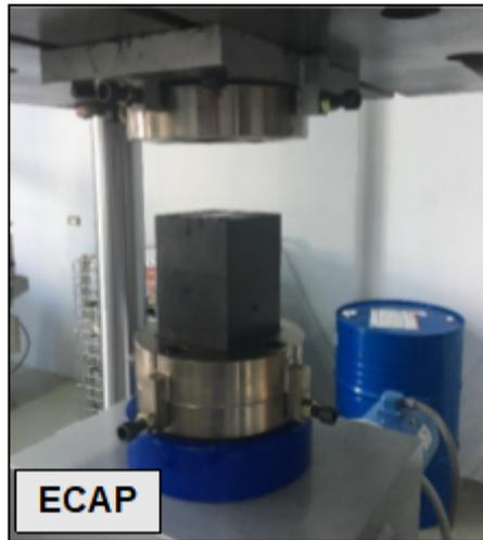
Proceso de Torsión de alta presión (HPT, arriba). y de Extrusión en canal angular constante (ECAP, abajo) y cómo se ven en el equipo que se desarrolló en el TEC. Imagen cortesía de Jorge Cubero.
