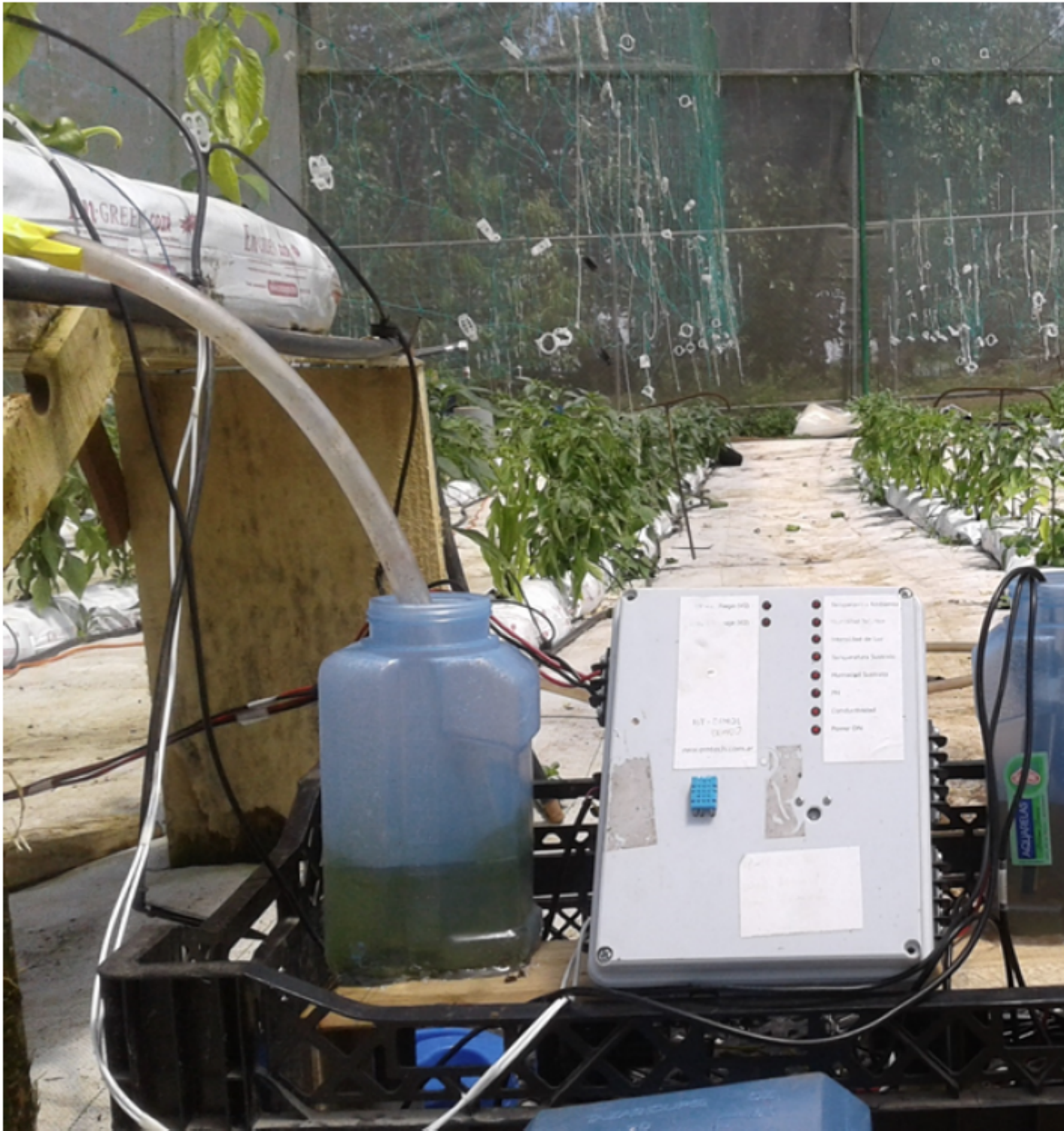
El drenaje de las plantas dispuestas en el Invernadero del TEC, utilizan un método que combina mediciones manuales y automáticas. Fotografía cortesía de Arys Carrasquilla.
