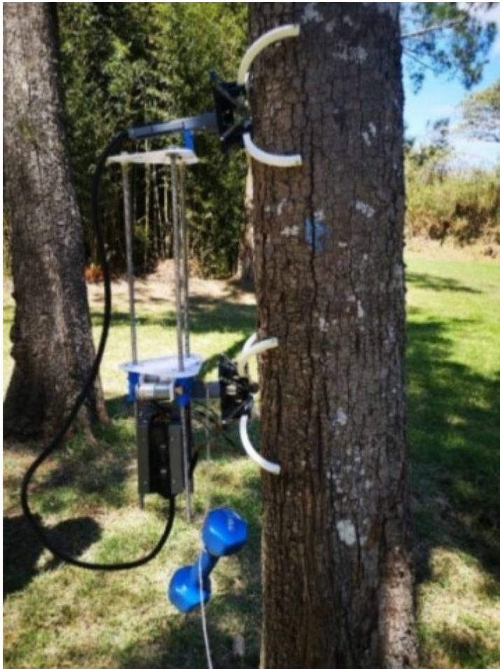
En esta prueba el robot está llevando una carga de 3 kilogramos. Foto cortesía de José Miguel Ortega.
