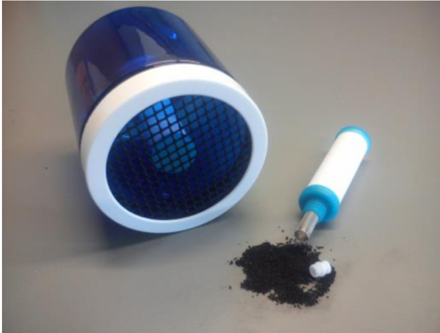
Muestreador pasivo desarrollado en la Universidad de Toronto. Imagen cortesía de Carlos Calleja.
