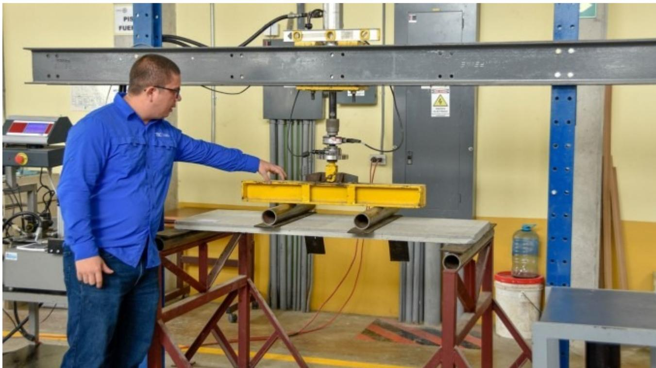
El ingeniero Ángel Navarro explicó sobre las pruebas que se realizan a las baldosas y demás elementos prefabricados en el Civco. **Foto: Steven Moya/TEC.**
