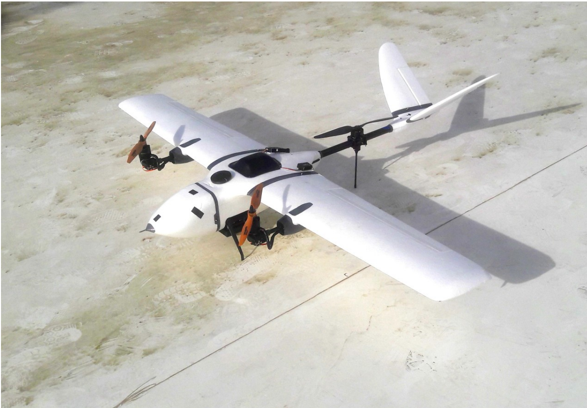
Aeronave de ala fija del tipo VTOL, que permite realizar despegues y aterrizajes verticales. Foto cortesía de Renato Rímolo Donadio.
