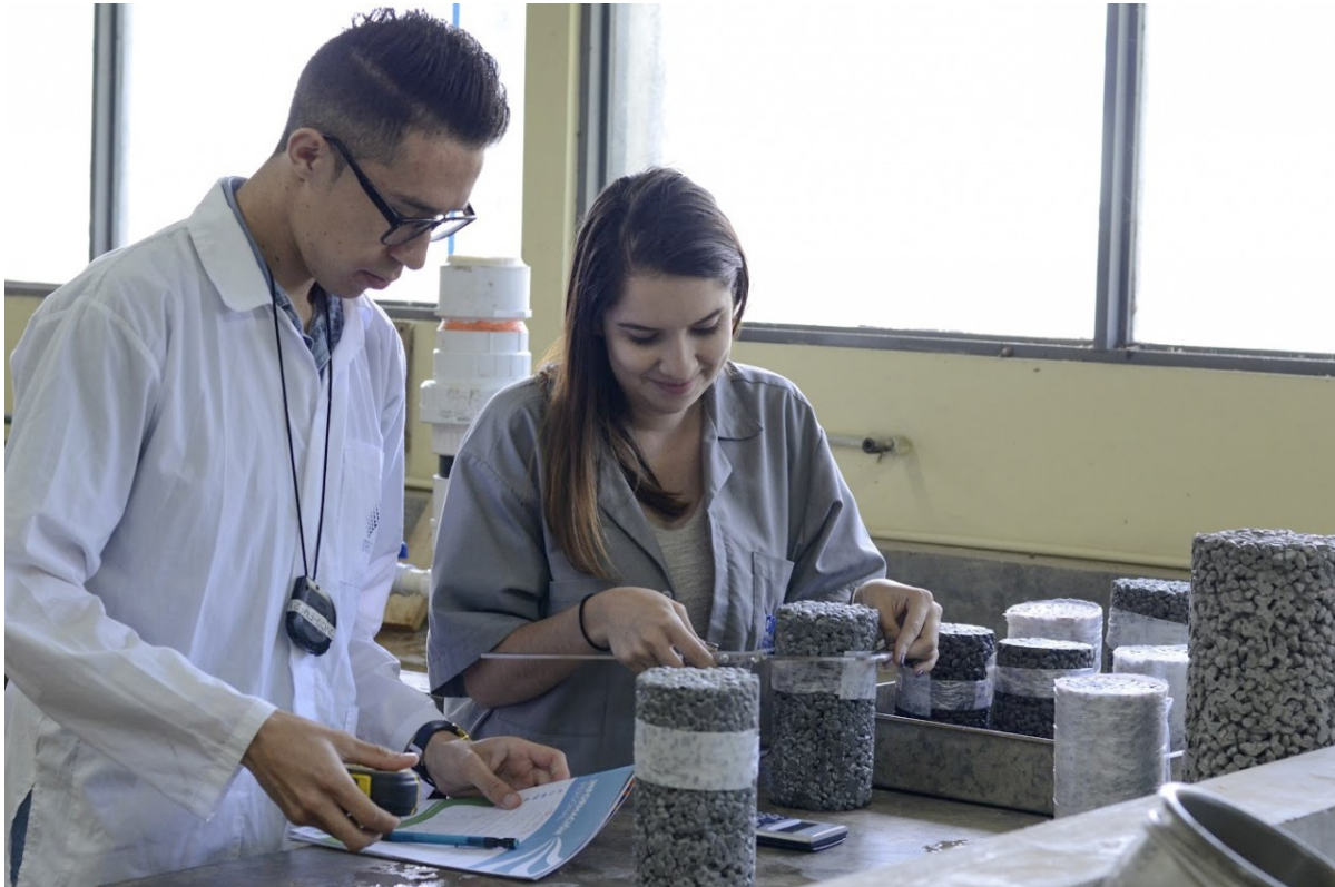
Los estudiantes realizaron las respectivas mediciones del concreto permeable. Foto de Steven Moya Barrientos /OCM .
