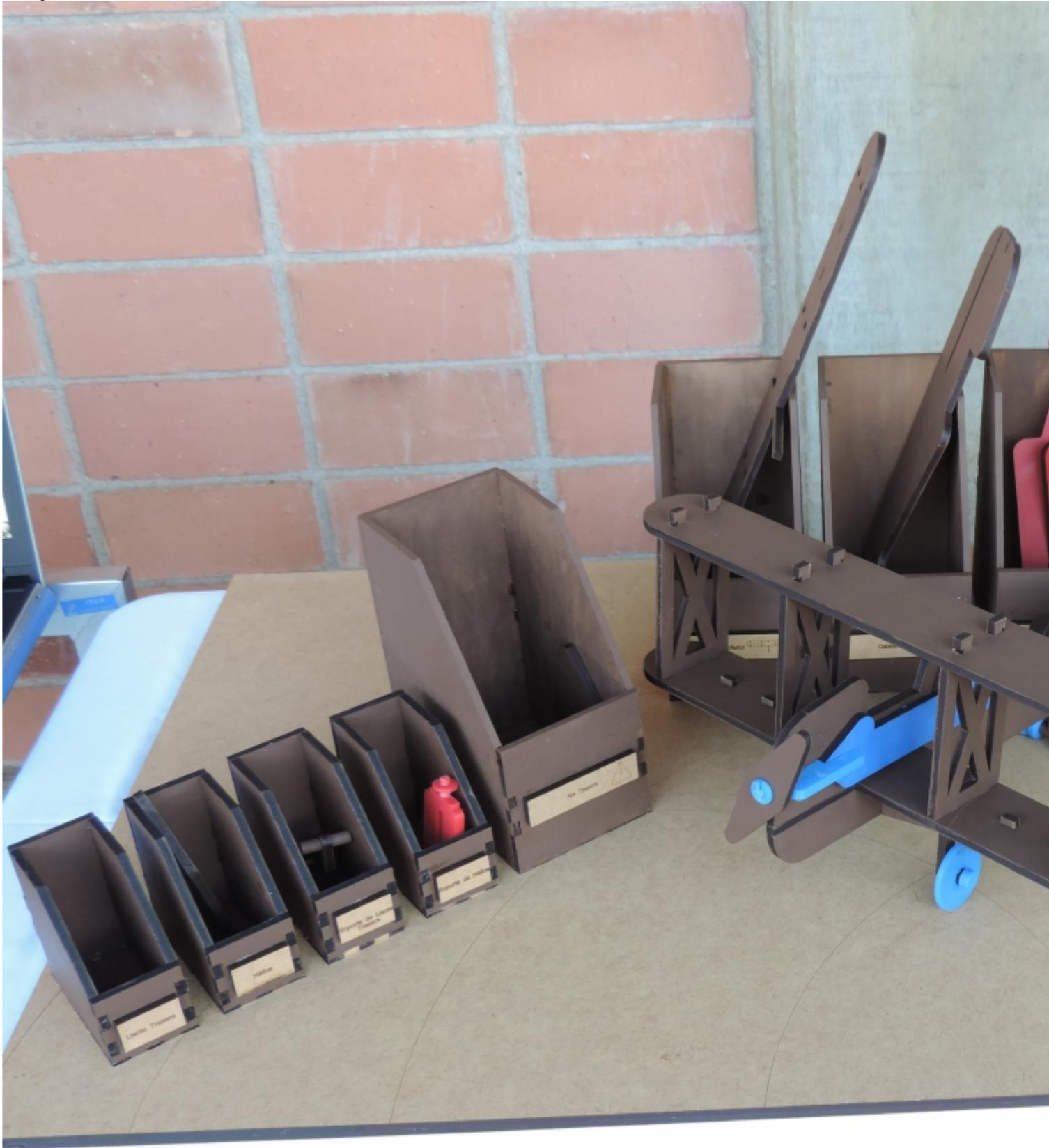
Consiste en el diseño y creación del puesto de trabajo didáctico en donde se ensamble un avión a escala. Dicho puesto será realizado con madera, la cual será maquinada en el *router*. El avión a escala tendrá piezas realizadas por medio de la cortadora láser y la impresora 3D.
