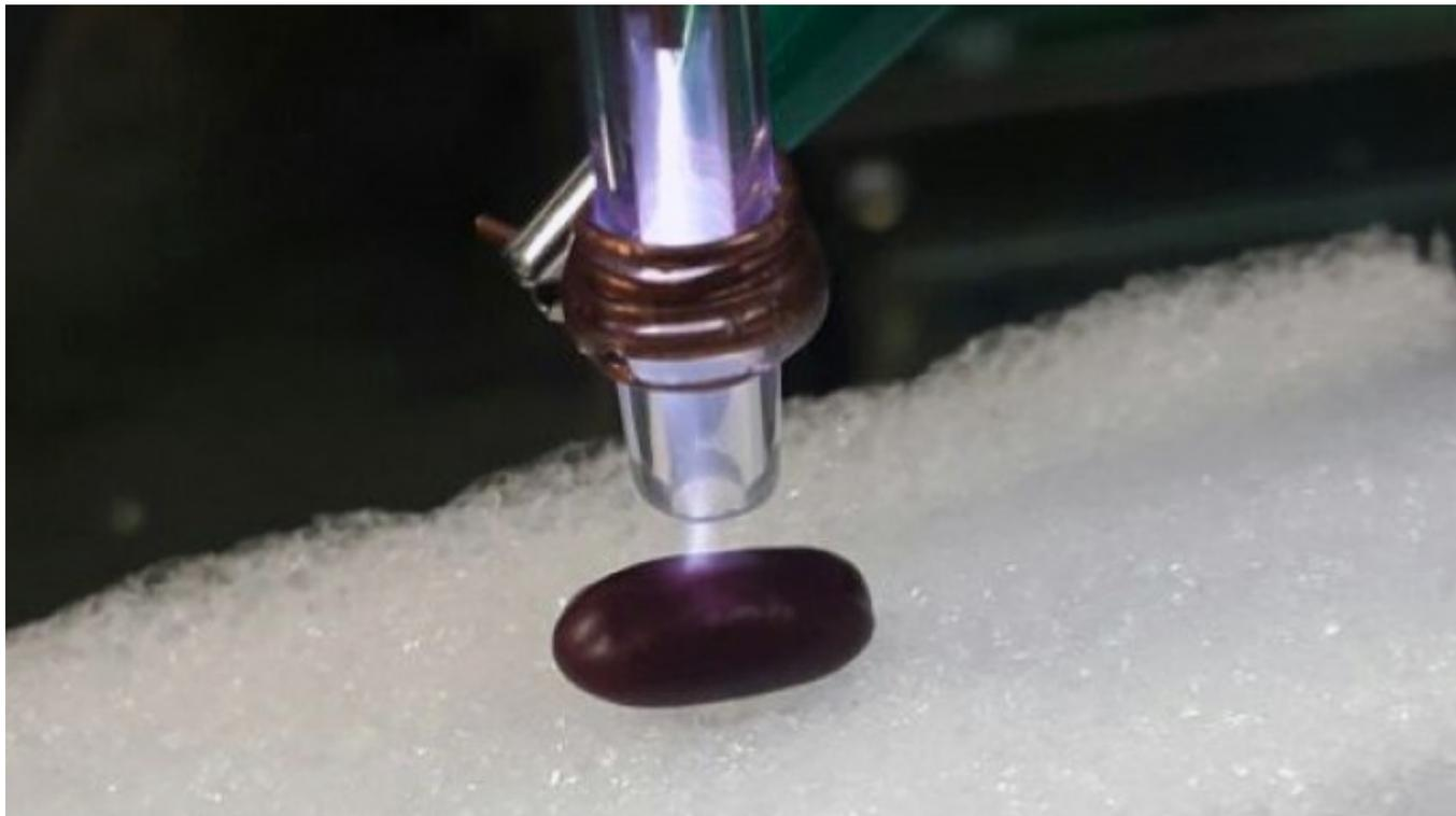
Irradiación de un grano de frijol en el Laboratorio de Plasmas. **Foto: Cortesía Laboratorio de Plasmas.**
