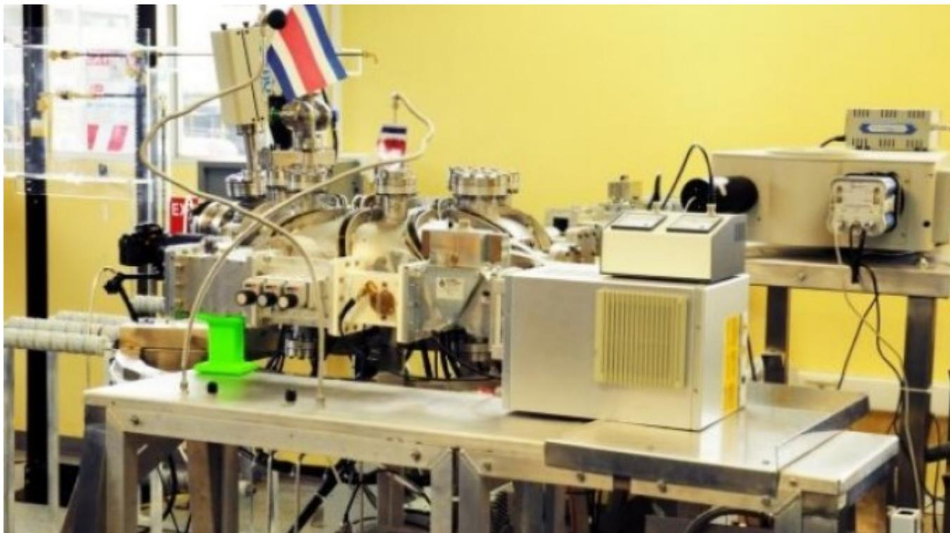
Este es el Stellarator de Costa Rica 1 (SCR -1), ubicado en el Laboratorio de Plasmas para Energía de Fusión y Aplicaciones del TEC. (Foto Ruth Garita/OCM)
