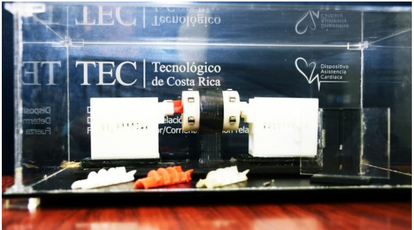
Dispositivo experimental de impulsor de sangre. (Foto: Ruth Garita [1] /OCM)
